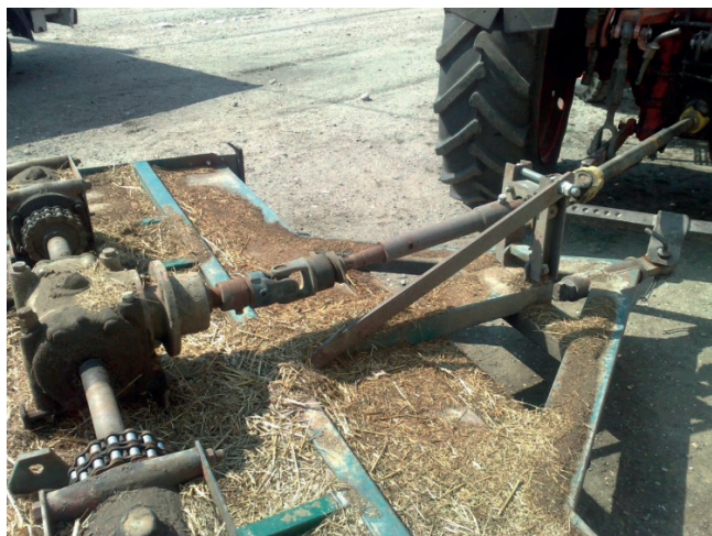
Védőburkolat nélküli kardántengely, ill. meghajtás
