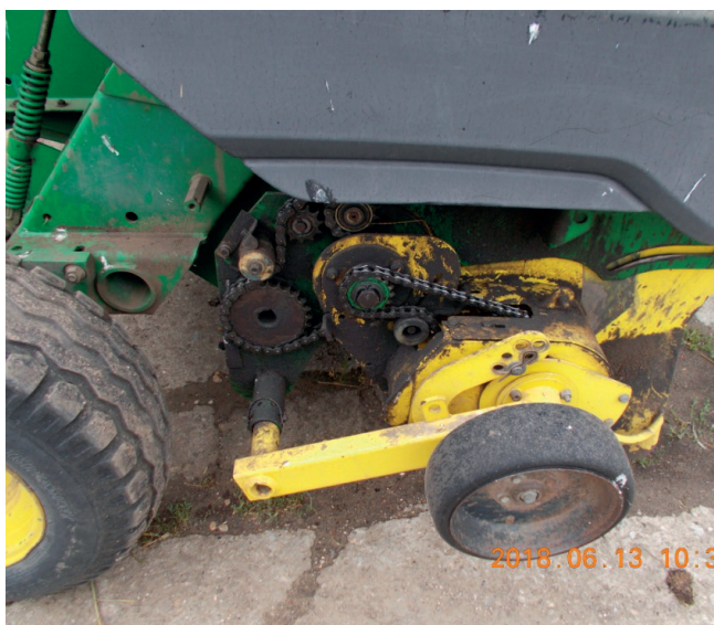
Bálázógép lánchajtásáról hiányzott a védőburkolat
